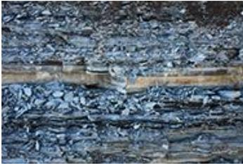
**Posidonienschiefer, ein schwieriger Baugrund,** der zur Gipskristallbildung neigt, wenn seine Wasserdampfsättigung aus dem Gleichgewicht gerät.
